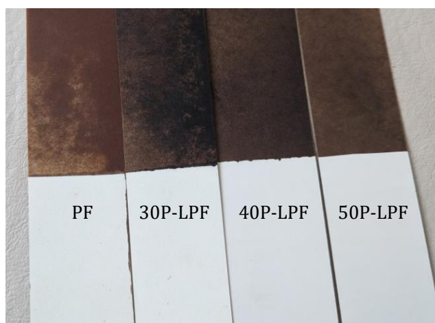
Figura 2. HPL (arriba) y HPDL (abajo) manufacturados en prensa de laboratorio.
