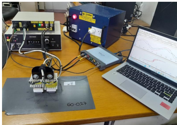
Figura 3. Fotografía del Sistema Experimental del ciclo de histéresis.
