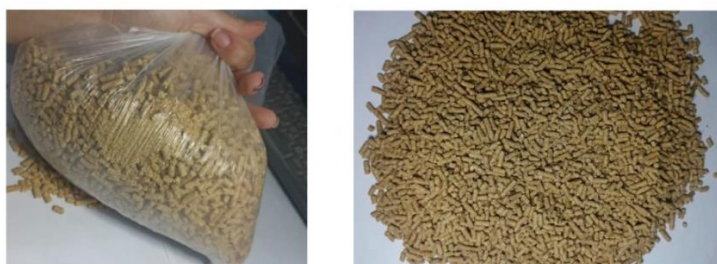
Figura 3. Análisis visual de muestra con inclusión de aglutinante. Testigó AE-TR + Pellet Fix 3.0 kg
